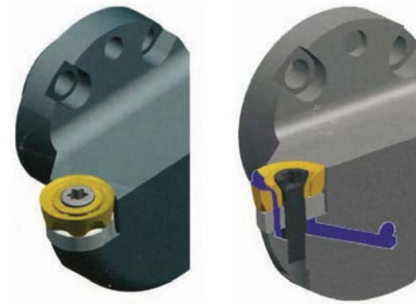
Rys. 9. Sposób doprowadzania chłodziwa do strefy skrawania poprzez ostrze skrawające (Kennametal)
